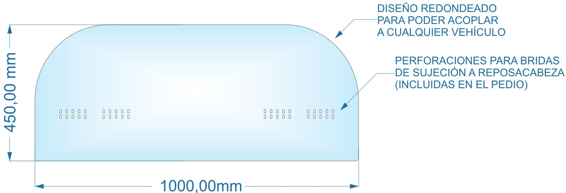
fabricadas en metacrilato transparente de 3mm
